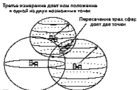
Рисунок 1.3 – Определение местонахождение на пересечении 3 «сфер»
