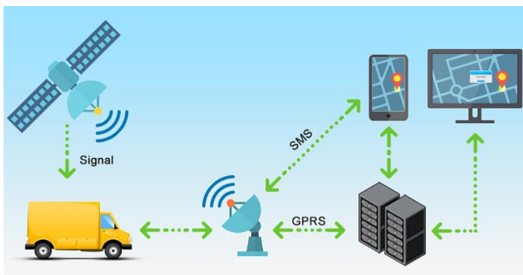
Рисунок 2.6 - Передача данных через GPRS
